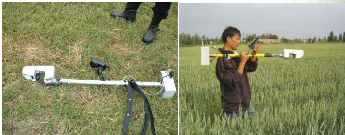
Фото. Внешний вид оптического сенсорного прибора и его применение на пшенице, Ургенчский район, Хорезм (И. Курязов)
