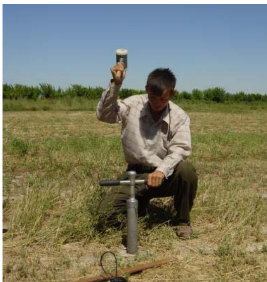
Фото. Отбор почвенного образца при традиционном методе измерения степени засоления почвы (А. Акрамханов)
