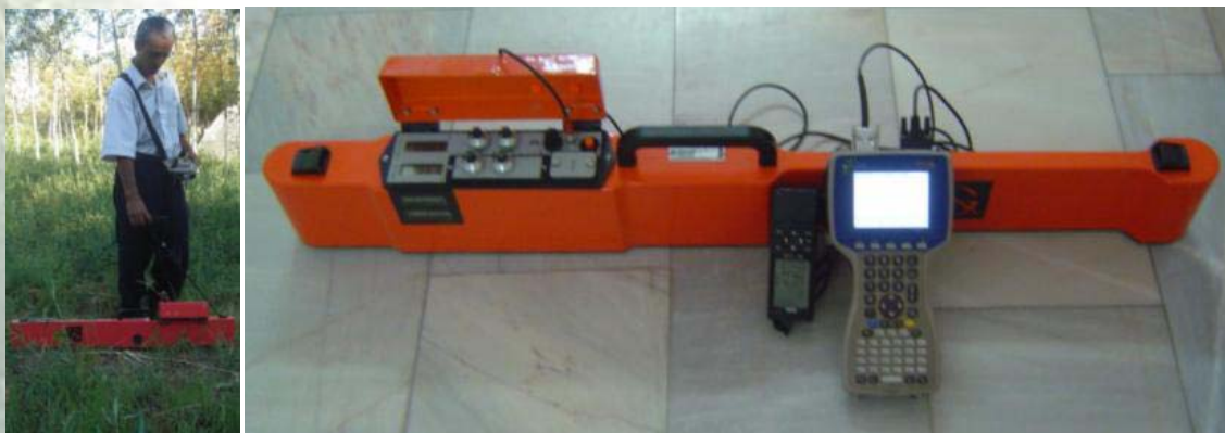
Фото. Внешний вид прибора EM38 (А. Акрамханов)
