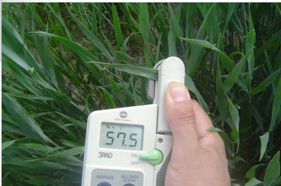
Фото. Внешний вид хлорофиллметра SPAD-502 (Ю. Джуманиязова)
